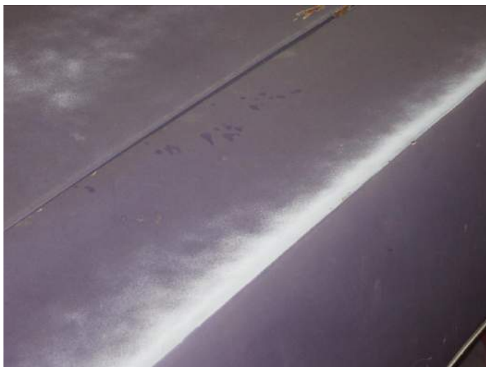
Una capa desteñida y gastada de pintura metálica en un Dodge Superbee 1970 –declarado como la primera pintura original–. Una reparación que copia este efecto visual no se realiza con procesos industriales. El violeta metálico está casi destrozado
