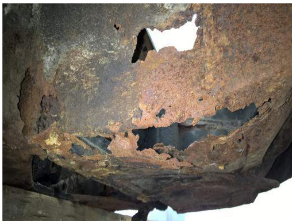
Guardabarros delantero de un Porsche 356 de 1963 – sin protección contra la corrosión. “El hobby más oxidado del mundo”.
